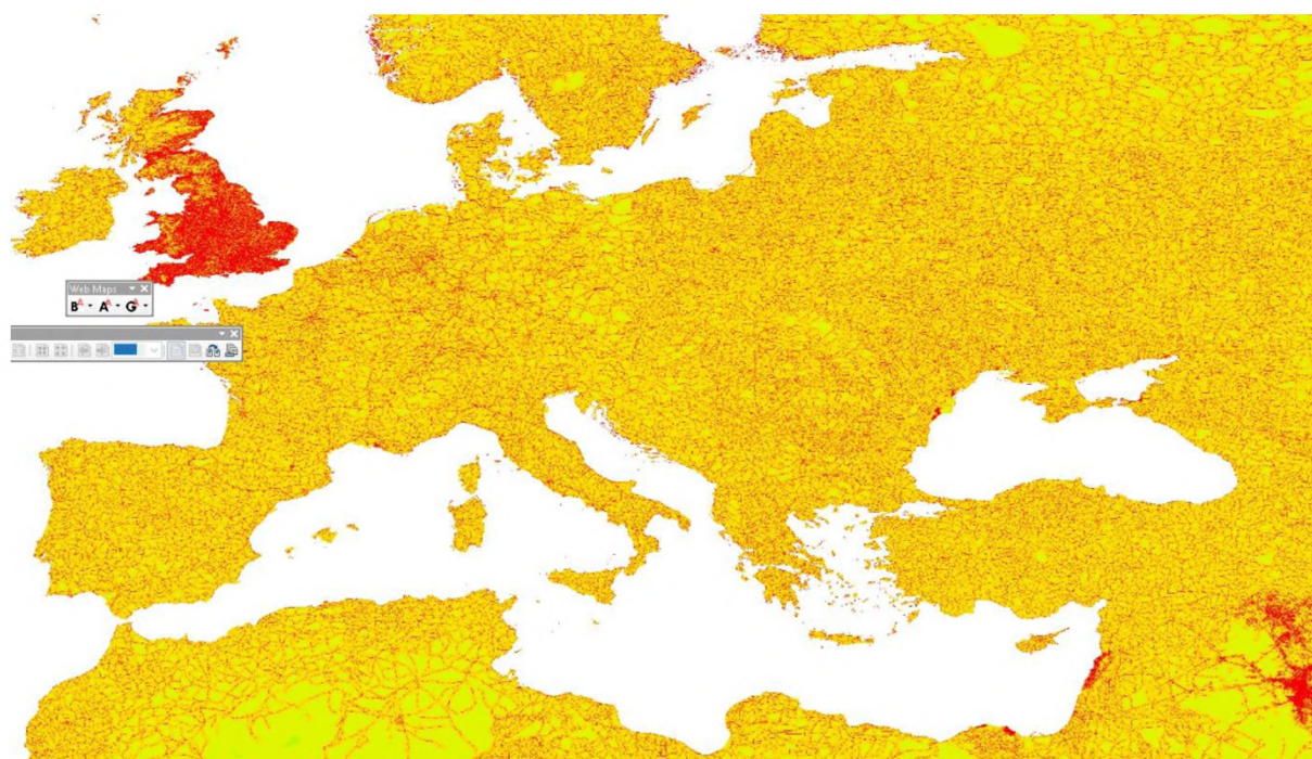
Рис. 1 Удалённость точек пространства от автомобильных дорог, полученная с помощью инструмента Euclidean distance (красным цветом обозначены территории, находящиеся на расстоянии 1 километра от автодорог).
