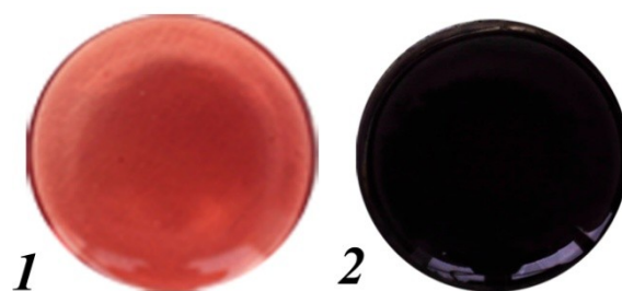
Рис. 4 Качественная реакция на дубильные вещества, содержащиеся в водном экстракте семян Jasminum fruticans : 1 – водный экстракт до внесения 1% раствора железоаммониевых квасцов; 2 – изменение окраски экстракта после добавления 1% раствора железоаммониевых квасцов
